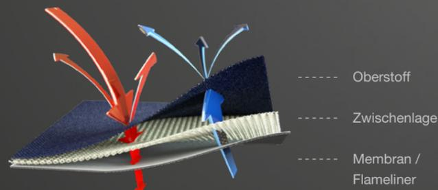
X-TREME® Light besteht aus drei Lagen: Oberstoff, Zwischenlage (Heat Comfort Barrier) und Membran/Flamliner (GORE-TEX Flamliner® G und GORE-TEX Nässe Sperre mit GORE® CROSSTECH® Produkttechnologie)
