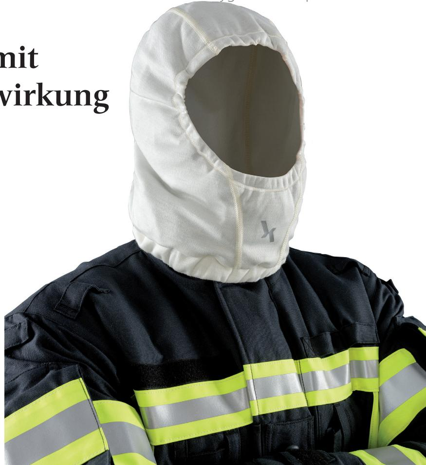
Durch das quasi Überkleben der Nähte, das Vertapen, in einem speziellen Arbeitsschritt weisen die Flammschutzhäuben eine nahezu 100 %ige Partikeldichtheit sowohl in der Fläche als auch an den Nähten auf (Fotos: Texport).
