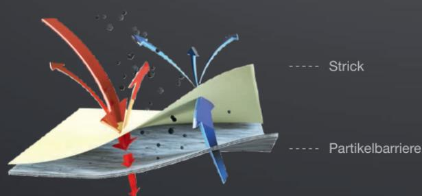
Der Materialaufbau PP 2lg besteht aus zwei Lagen: Strick, Partikelbarriere.
