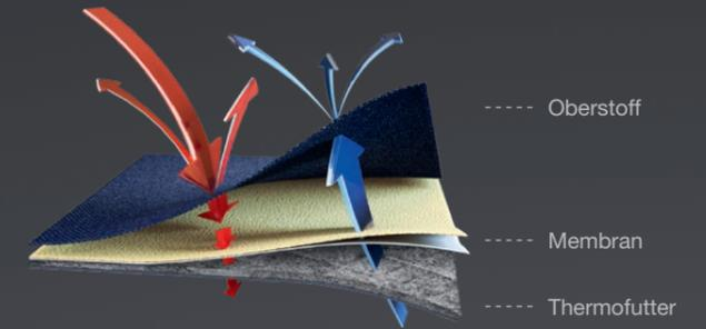
Der FIRE BASIC Materialaufbau besteht aus drei Lagen: Oberstoff, Membran (GORE-TEX Fireblocker N) und Thermofutter (Aramid Fleece)
